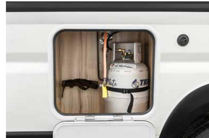
Ungewöhnlich für Campervans ist der Zugang zum Gaskasten von außen, so dass die Gasflasche bequem gewechselt werden kann, ohne den Kofferraum zu leeren.
