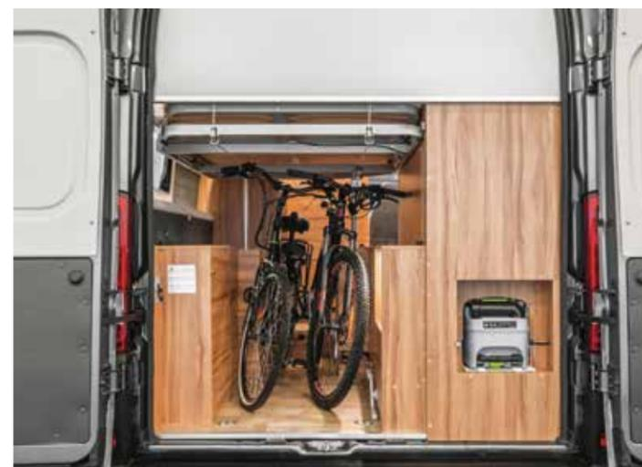
Das französische Bett im Heck des Fahrzeugs ist mit einem Hubsystem ausgestattet. Damit lässt sich der Bettrahmen so weit anheben, dass zwei Fahrräder im Fahrzeug transportiert werden können. Der Hebemechanismus wird elektrisch betrieben.
