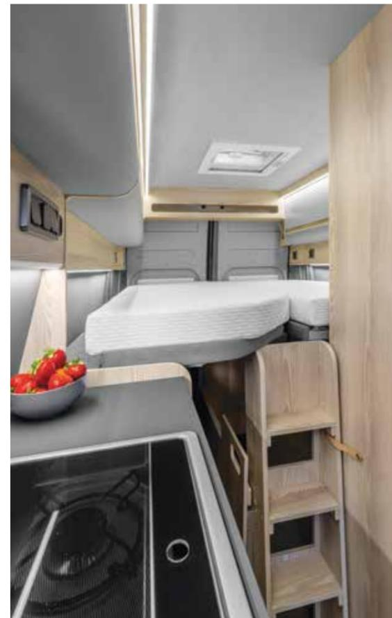
Das klappbare Schranksystem und der hebbare Oberboden ermöglichen, den Gepäckraum deutlich zu vergrößern. Das elektrisch hebbare Bett macht den gesamten Vorgang schnell und bequem. Der Zugang zum Bett in der oberen Position wird durch Stufen ermöglicht, die während der Fahrt unter dem Boden verstaut sind.
